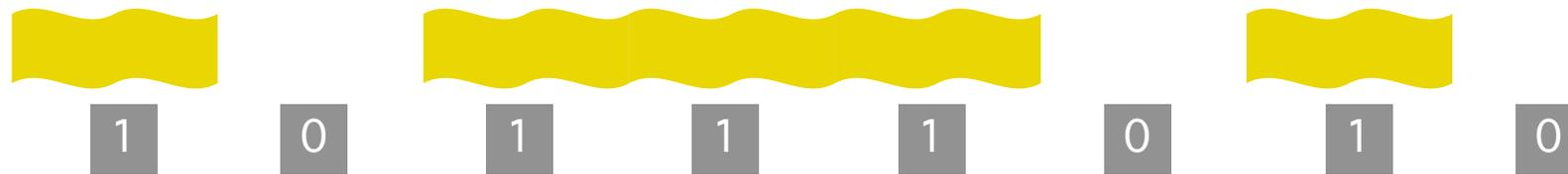
questa modulazione di “portante” costituisce il “codice” secondo cui noi trasmettiamo informazione: nell’esempio fatto il codice è “binario” cioè presenta solo due stati: 1 e 0: con il codice binario si possono scrivere numeri di qualsiasi complessità e quindi trasmettere qualsiasi informazione: oggi tutta l’informazione trasmessa viene resa un numero e poi codificata in BIT, cioè Binary Unit: in altri termini si dice che tutte le reti sono “digitali”
